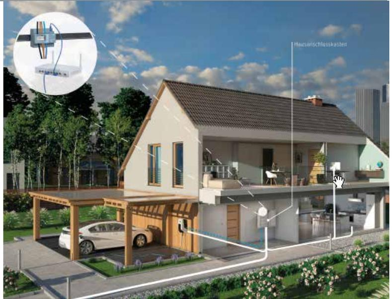
Die Vernetzung zwischen Energiezähler und der Ladestation kann über eine Direktverbindung oder über einen Ethernet-Switch erfolgen. Die Ladestationen ist mit folgenden Energiezählern kompatibel: LCD Standard-Leistungsmessgerät / 3P / 5A.
